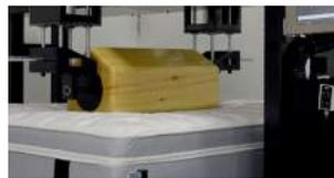
**롤링 테스트** ASTM F 1566-09
